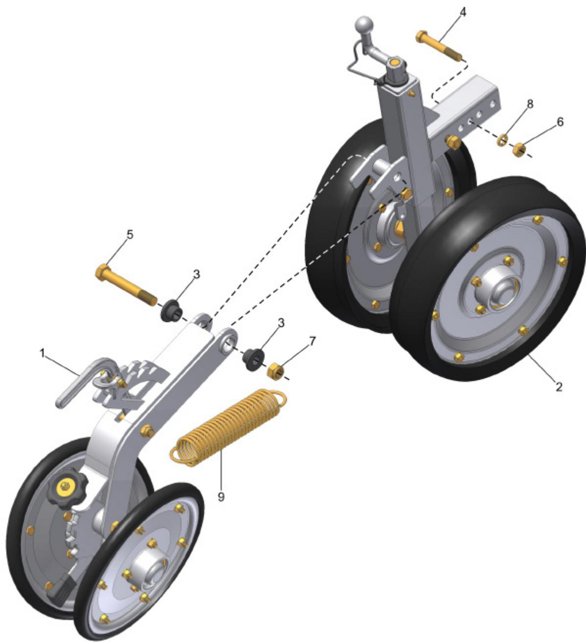
**CM LIMITADOR FIXO COM ESCALA/ BANDA COMPACTADORA "V"**
