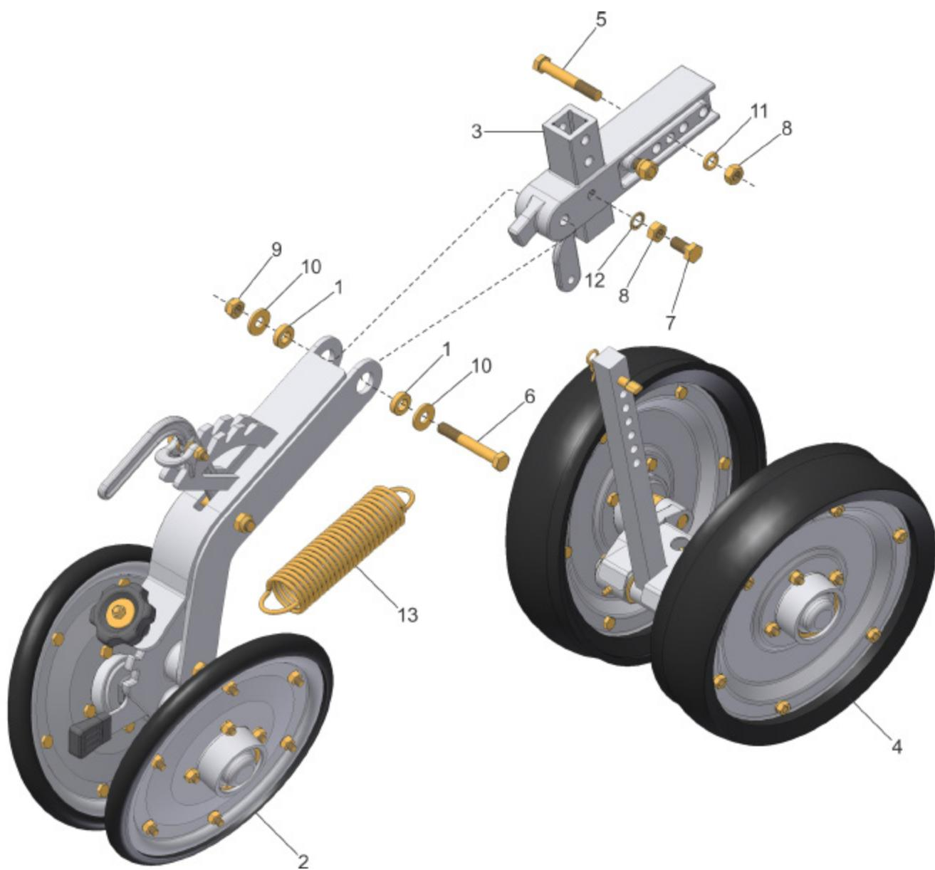
**CM LIMITADOR INDEPENDENTE/ BANDA COMPACTADORA "V"**
