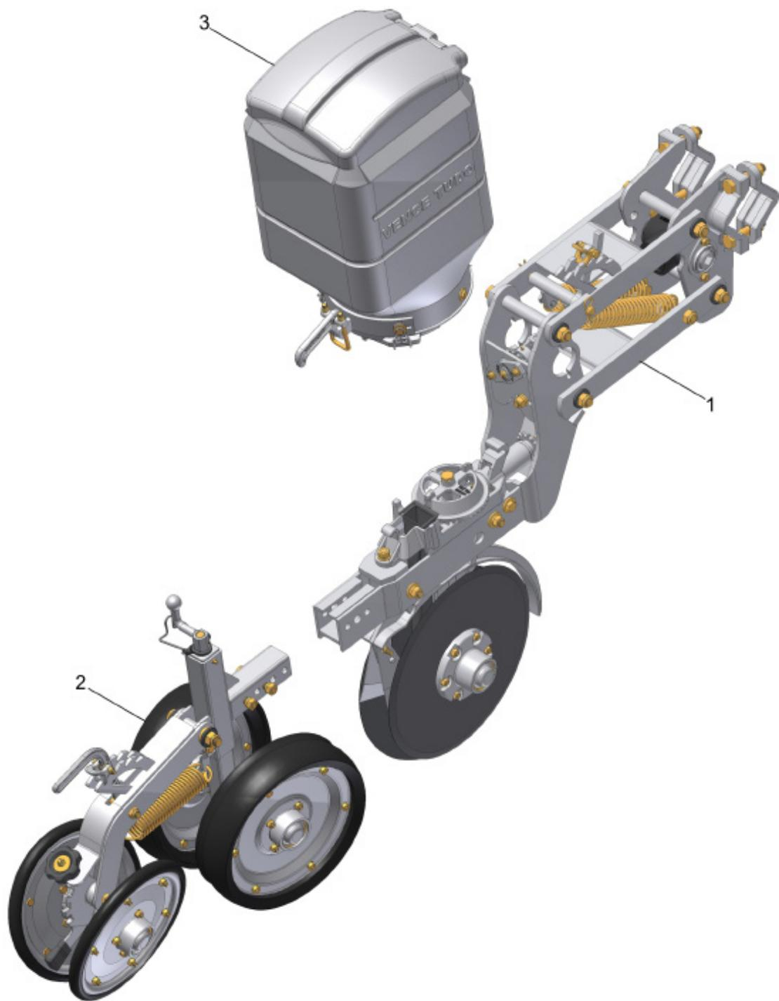
**CM LINHA SEMENTE COM DISTRIBUIDOR - LIMITADOR FIXO COM ESCALA BANDA COMPACTADORA EM "V" (Soja-Milho)**
